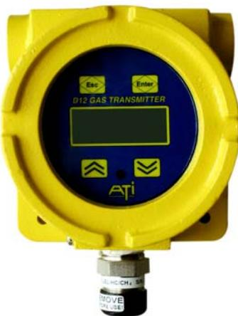
ATI 的 D12 系列气体检测仪扩展了, 增加了 D12-IR 红外气体检测仪。D12-IR 红外传感器吸收被测气体或蒸汽的红外能量。形成与其气体浓度成正比的信号。传感器封装于不锈钢外壳中, 防腐防撞击, 适用于多种安装环境。
